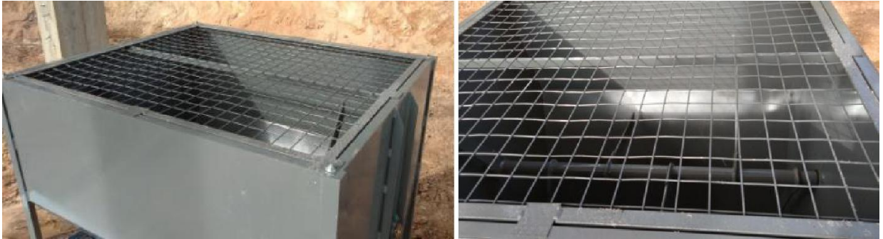
Fotos 36 e 37: grade de proteção de abastecimento de material do alimentador
