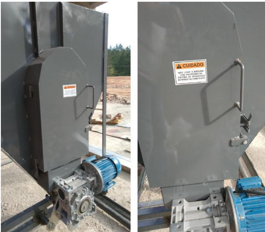
Fotos 24 e 25: sinalização proteção
