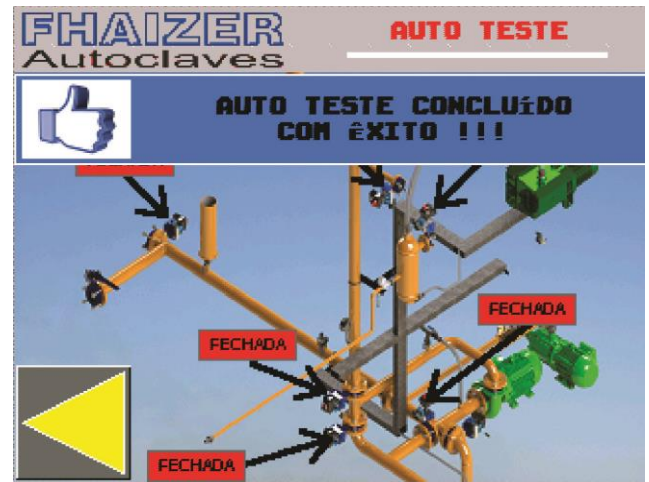
Figura 174 - Teste de válvulas.
