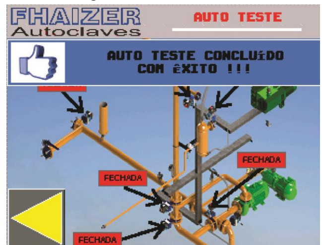
Figura 163 - Teste de válvulas.
