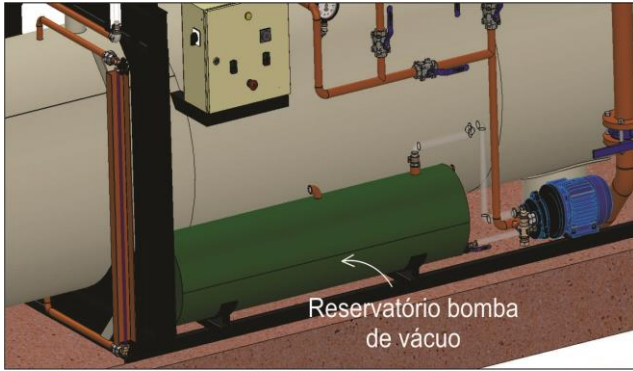
Figura 81 - Reservatório da bomba de vácuo.
