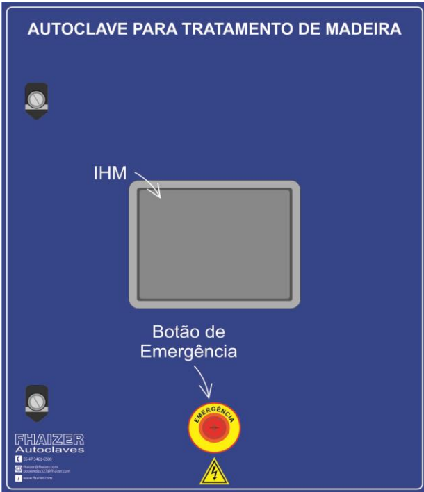
Figura 130 - Painel de comando modelo automatizado.
