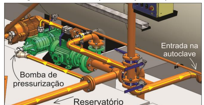
Figura 91 - Sistema de pressurização de líquido.
