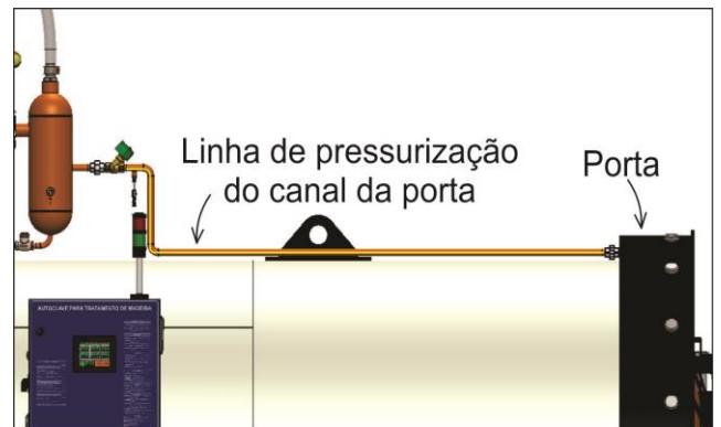
Figura 119 - Linha de pressurização do canal da porta.
